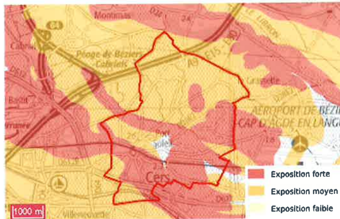
Figure 4 : Carte de l'aléa retrait-gonflement des argiles sur la commune de Cers (Source : Géorisques)
